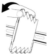
Отсоедините модуль семейства 3000 от рейки DIN, поднимая за установочный зажим.
